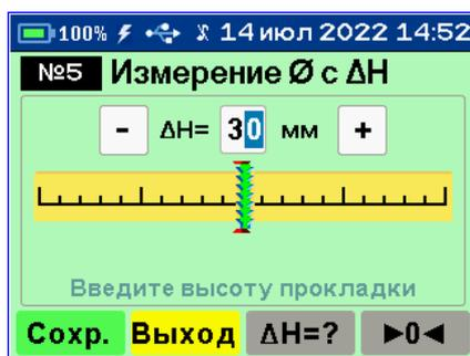
Для измерения диаметра арматуры в режиме «**Измер. Ø с ΔН**» используйте прокладку известной толщины от 10 до 60 мм из любого диэлектрического материала (дерево, пластмасса, керамика и т.п.).
