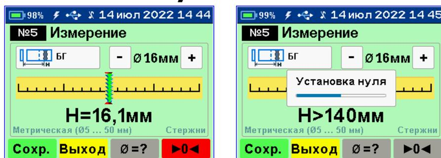
После завершения автокоррекции нуля прибор вернется в режим измерения.
