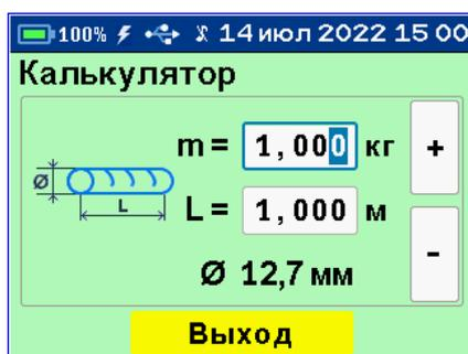
Позволяет вычислять один из трех взаимосвязанных параметров арматуры (масса, длина, диаметр), используя два известных.
