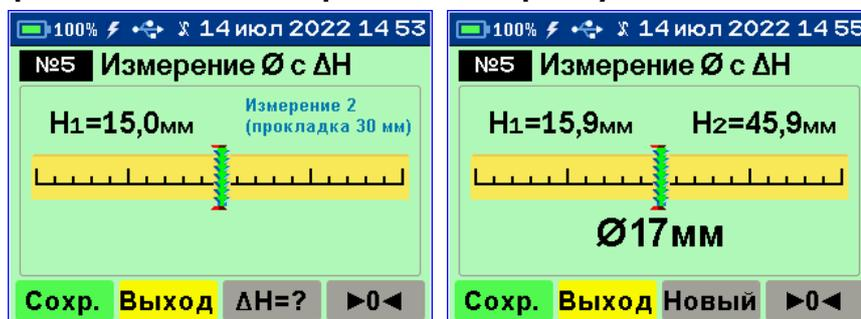
Режим с использованием прокладки обладает пониженной точностью определения диаметра и рекомендуется для использования только при большой толщине защитного слоя бетона в случае, когда основной режим работы не применим.
